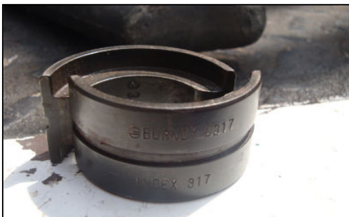
Figura N°2. Dado de Compresión Y35.
