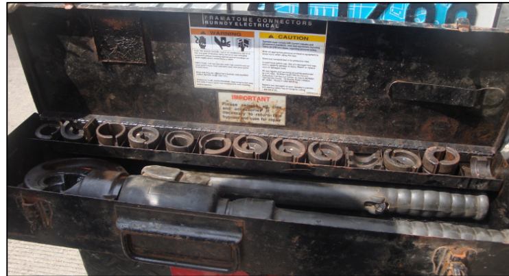
Figura N°4. Herramienta Y35 con Dados.
