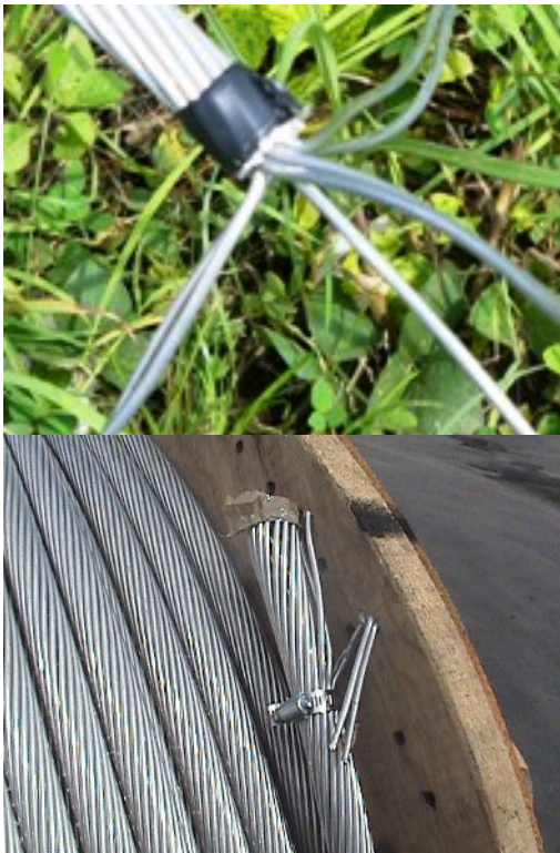
Figura N° 9. Los extremos del conductor deben estar permanentemente sellados o con sus puntas amarradas (en el carrete, en rollos sueltos o durante el manejo).
