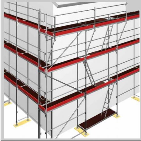
Andamio de fachada
