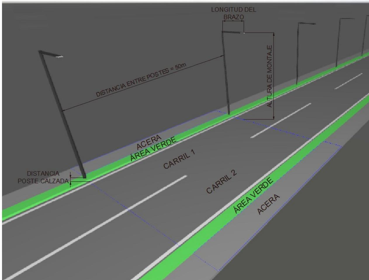
Las luminarias del Módulo 2 reemplazaran a las luminarias HPS de 250W
