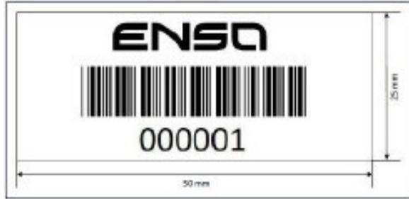
**Nota:** Fabrica debe enviar a ENSA una muestra de la etiqueta de código de barra que colocara a la luminaria, antes de iniciar producción, con el fin que ENSA pueda verificar la lectura.
