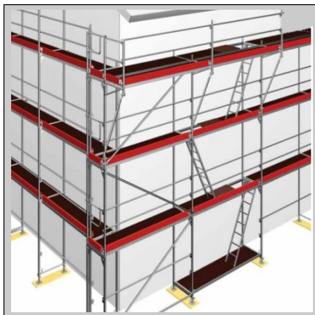
Andamio de fachada
