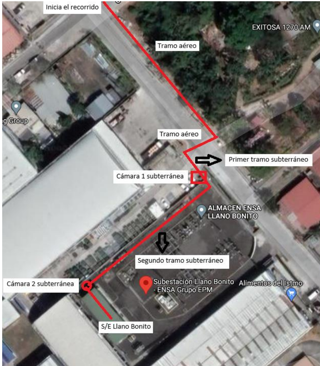
Figura 4: Recorrido de las dos fibras ópticas (en color rojo). Desde los postes de distribución hasta la S/E Llano Bonito.
