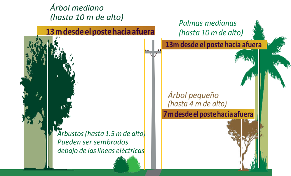
Figura 1. El tamaño de los árboles está dado en función de su altura en edad madura. La distancia recomendada para plantar contempla un margen adicional de seguridad de 3 metros, así se garantiza que no se plante los árboles debajo del tendido eléctrico.
