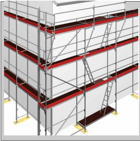
Andamio de fachada
